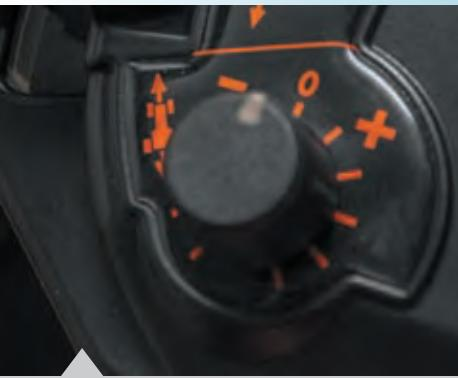
**Ручка системы регулировки плавности хода**
