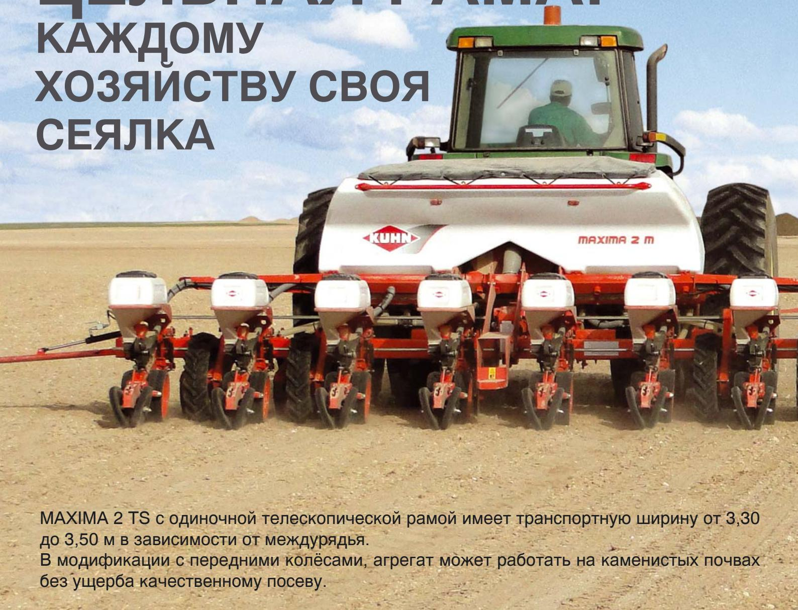
MAXIMA 2 TS с одиночной телескопической рамой имеет транспортную ширину от 3,30 до 3,50 м в зависимости от междурядья.
