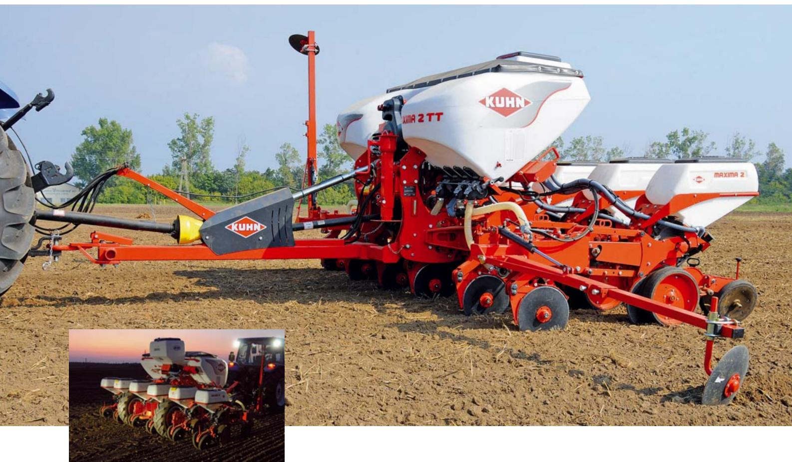
Для снижения дорожных габаритов, MAXIMA 2 ТТ поставляется в модификации из 6 рядов с возможностью уменьшить габаритную ширину до 3,50 м.
